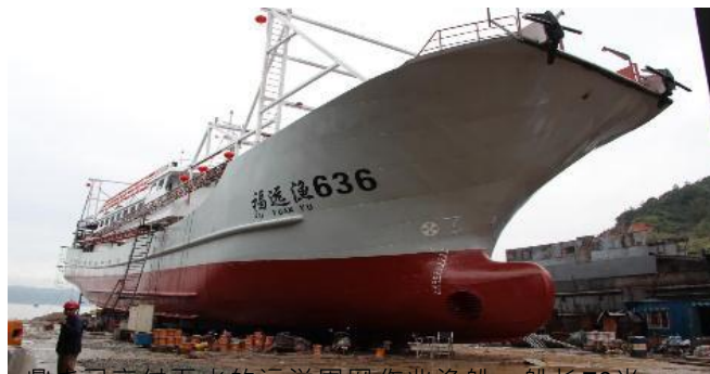
鼎丰已交付下水的远洋围网作业渔船，船长70米，宽11.5米，深5米，总吨位1,600吨。是福建地区吨位最大、设备最先进的捕捞渔船
